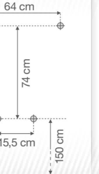
2. Bohren Sie die 4 gekennzeichneten Löcher mit 14 mm Durchmesser 120 mm Tiefe in die Wand und stecken Sie die 4 Dübel in die Löcher.
